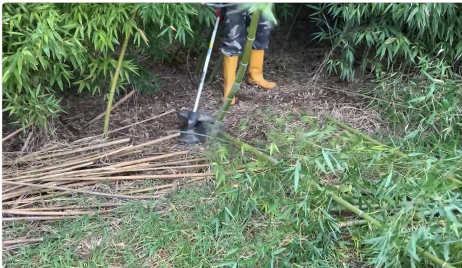
Il taglio delle canne con decespugliatore dotato di disco Widia.
