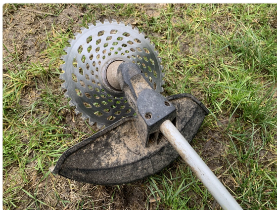
La testa di un decespugliatore con montato un disco Widia, per il taglio delle canne più grosse.
